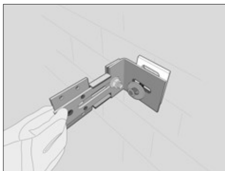
Если требуется установка изоляции большей толщины то для установки подсистемы можно использовать кронштейны.
